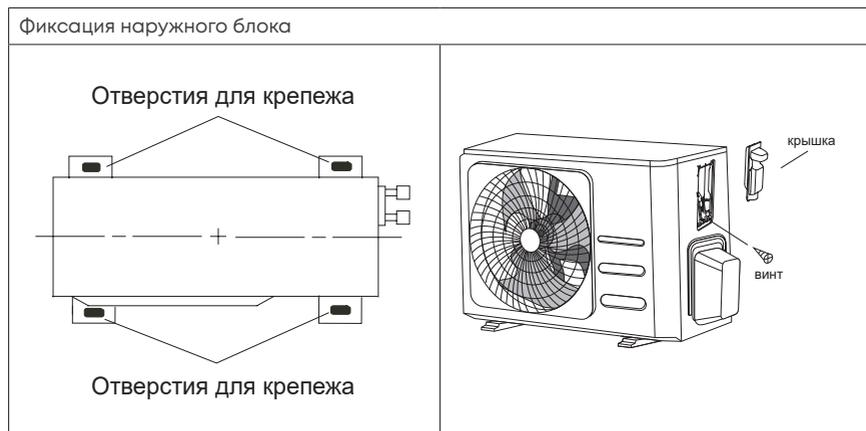
Зафиксируйте наружный блок 4 болтами.
