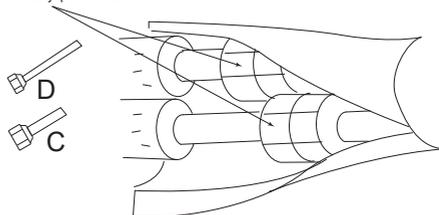
После проверки на предмет утечек плотно заизолируйте место соединения штуцеров внутреннего блока с трубами хладагента теплоизолирующей лентой.
