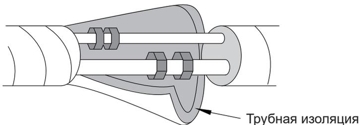
Абсолютно все элементы трассы хладагента нуждаются в теплоизоляции. При ее отсутствии возможно возникновение двух проблем: первая связана со снижением КПД установки из-за тепловых потерь, а вторая с образованием конденсата на поверхности труб.
